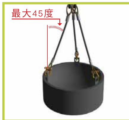
1.5 使用三條吊索時，支腳與垂直線的夾角不可超過45度。
