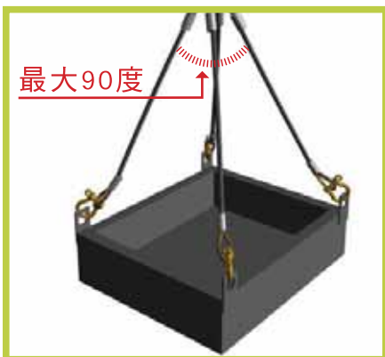
1.4 使用兩條或四條吊索時，吊索間的夾角不可超過90度。
