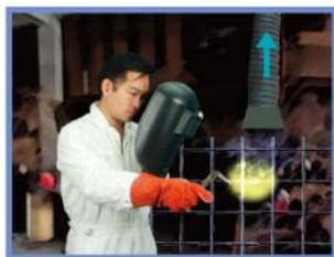
4. 燒焊時，將局部抽風設備的抽氣罩放近產生有害煙霧的源頭，可避免僱員吸入有害煙霧引致中毒。
