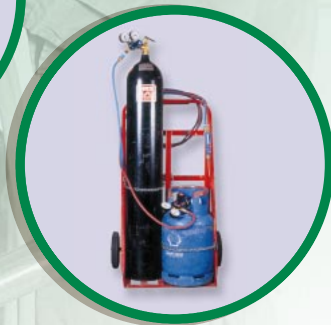
氧氣液化石油氣焊接
